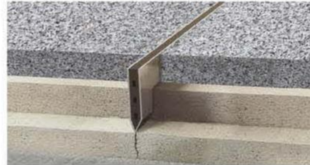
饰面材料变形缝装置
