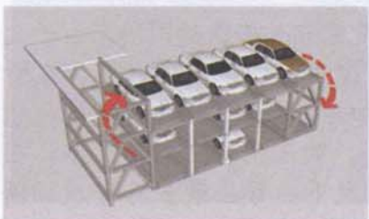
④ 设备循环，黄色车辆移到最右端
