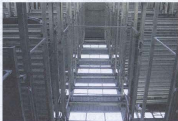
图A3-4 停车设备图（升降通道）
