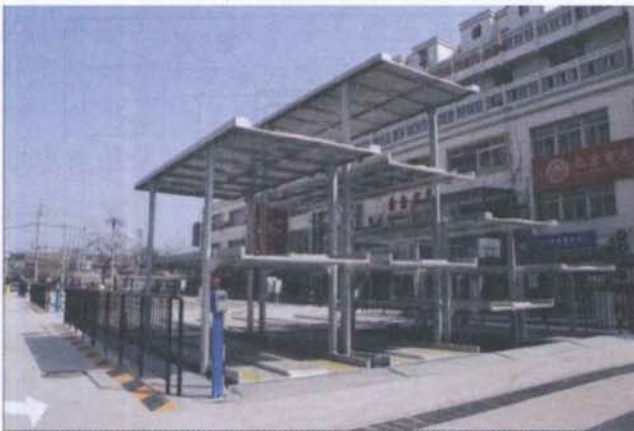
图B2-5 停车设备图（升起时）
