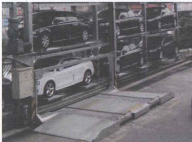
图D3-3 载车板 (落地时)
