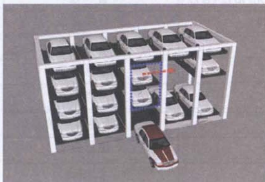
步骤一：车辆驶入载车板
