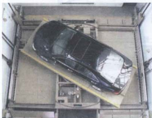
图C9-3 设备升降系统（旋转时）
