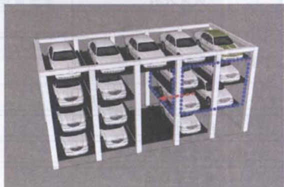
步骤一：车位平移空出通道
