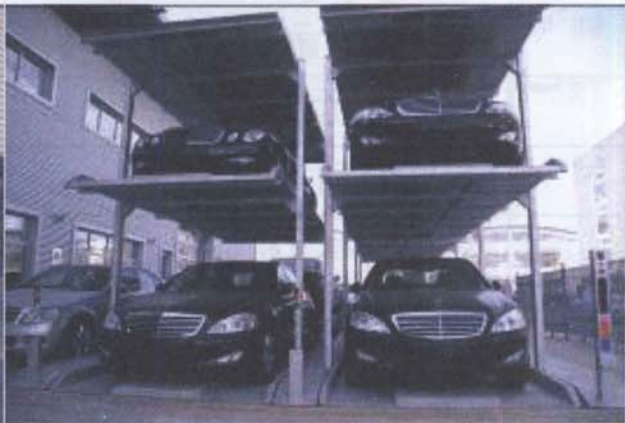
图B1-4 停车设备图（升起时）
