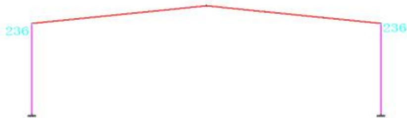
图4 附加重量放在全部柱顶模型简图
