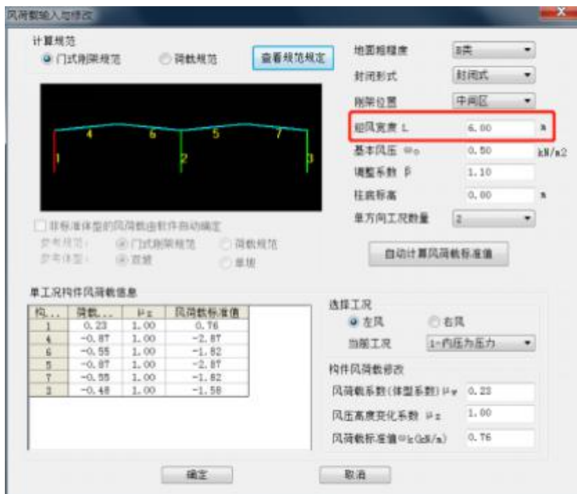
图5 门式刚架迎风宽度参数
