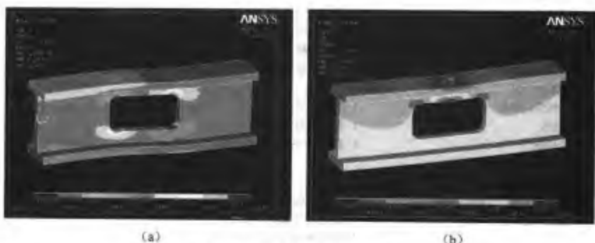
图 12-15 模型轴向应力分布图
