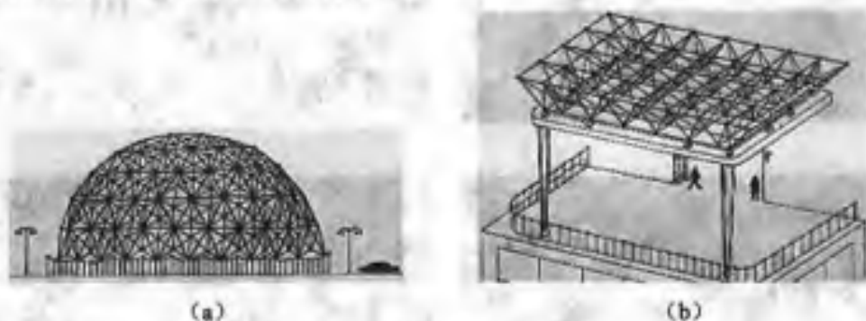
图 15-1 空间结构的工程实例
