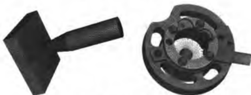
图 1-4 实体结构离散化的例子
