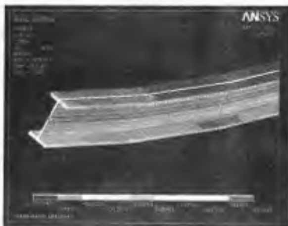
图 8-43 吊车梁的轴向应力分布图（载荷步 1）
