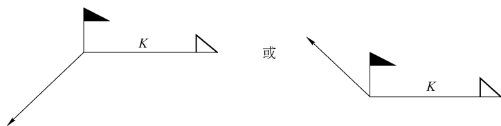
图 1-17 现场焊缝的表示方法
