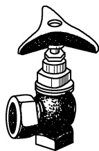
图10-3 供水直角阀结构
